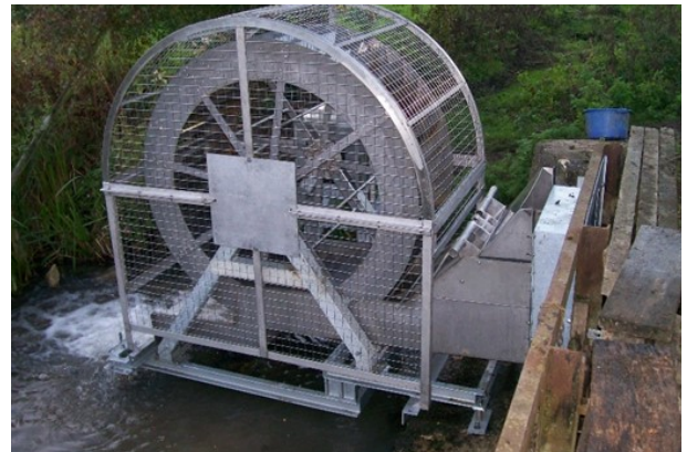
Overslagrad van de historische Heetveldmolen (Galmaarden, be) en een modern onderslagrad (Alternative Energy Service)
